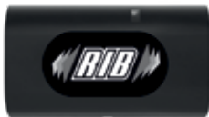
ACG9420B RADAR MICROONDAS Altura montaje H 1,8÷4 m 24.125 GHz - -20÷+60 °C IP 54 - 120x64x44
